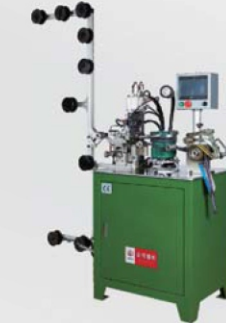
全自动金属上止机(U型) Full automatic metal upper stop (U type)
